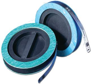
使い勝手が良く経済的な高耐食性グラファイト破裂板です。含浸グラファイト製で、破裂圧力が低く、腐食性の高い媒体用途に最適です。BS&B社のグラファイト破裂板は、ガスケット付きで、国際規格適合のパイプフランジ間に直接取り付けることができます。グラファイ製破裂板をパイプフランジへ設置前に、交換可能エレメントをグラファイトまたはステンレス鋼製ホルダに取り付けてください。
